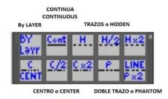
En un proyecto puede ser necesario indicar una tubería existente sobre el nuevo isométrico, o tubería a desmontar, etc. Para estos casos según la definición de cada proyecto se usan estos cambios de líneas.
